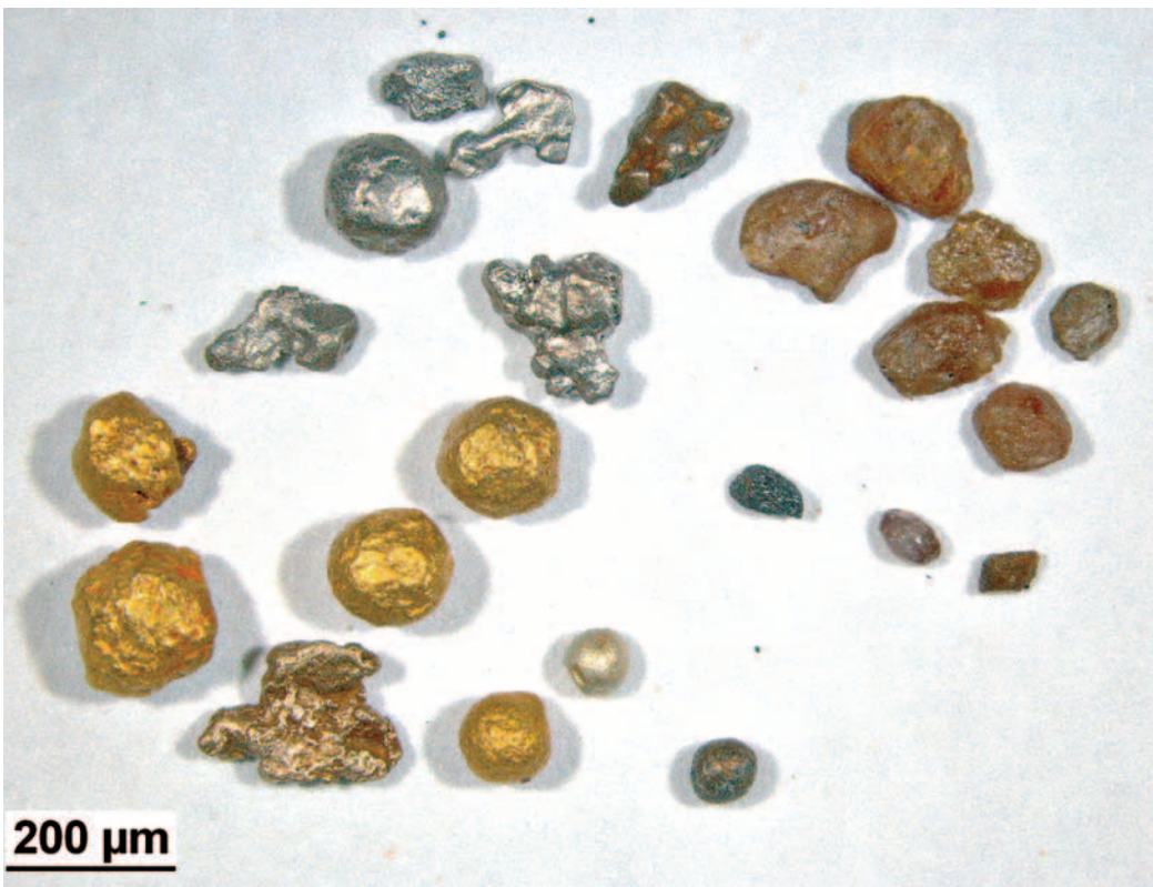
Kuva 4. Makroskooppikuva Puskuojalta Aarne Alhosen valtaukselta löytyneistä monatsiitti (punertavan ruskeita)-, zirkoni (suippoja pieniä), Cr-Ni teräs (pyöreä, alhaalla), Au-Ag-Zn-Cu metalli (hopeanvärinen, pyöreä), kulta- (yksi Pd-pitoinen, ruskehtava) ja isoferroplatinahipuista (kirkkaat hopeanväriset) ja ilmeniittiä (tumman ruskea, ylhäällä).
