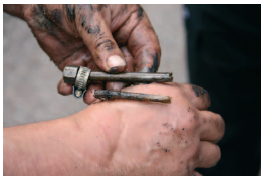
Pingonin polttoaineletkusta löytynyt puutappi, joka esti polttoaineen saannin.
