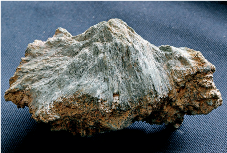
Kaitaselän kalsedonijuoneen yhteydestä tavattiin kuitumaista tremoliittia. Lapista ei vielä ole löydetty nefriittia, joka on hyvin hienorakeista ja samalla kuituista tremoliittikiveä. Juonen lähellä voisi hyvinkin esiintyä myös tätä näytettä hienorakeisempaa tremoliittikiveä. Näytteen leveys 8 cm. Kuva: Satu Hietala
