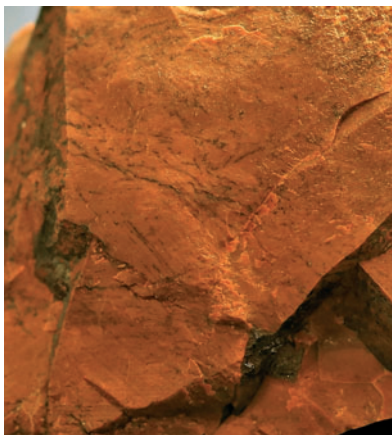
Kaitaselän ruskeassa kalsedonissa on pieniä dendriittejä ja haamumaisia jäänteitä muuttuneista mineraaleista, mahdollisesti karbonaateista. Kuvan leveys 4 cm. Kuva: Satu Hietala
