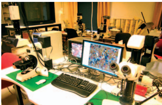
Kuva 3. Makroskoopilla (oikealla) voitiin irtonaisia rakeita tutkia optisesti binokulaarilla ja digitaaliselta näytöltä ja tallentaa kuvatiedostoksi. Polarisaatiomikroskooppia (vasemmalla) käytetään malmi- ja silikaatimineraalien tutkimusta varten pinta- ja ohuthieistä.
