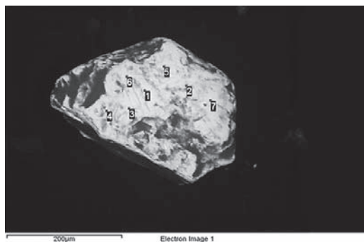
Kuva 20. Kuvassa on luberoiittirae, jonka koostumus on keskiarvona seitsemästä analyysistä: Se 20,56, Te 2,45 ja Pt76,99. EDS-analyysit ja SEM-kuva Kari Kojonen.
