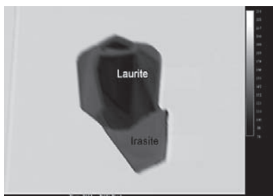
Kuva 36. Lauriitti- ja irarsiittirakeita sulkeumina isoferroplatinassa. BSE-kuva Fr. Stephanie Heidrich, Hampurin yliopisto. Mittakaava vasemmassa alareunassa 20 mikronia.
