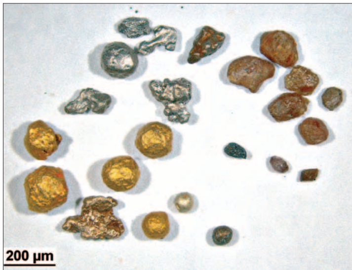
Puskuojalta Aarne Alhosen valtaukselta löytyneitä monatsiitti- (punertavan ruskeita), zirkoni- (suippoja pieniä), Cr-Ni teräs- (pyöreä, alhaalla), Au-Ag-Zn-Cu metalli- (hopeanvärisen, pyöreä), kulta- (yksi Pd-pitoinen, ruskeh-tava) ja isoferroplatinahippuja (kirkkaat hopeanväriset) sekä ilmeniittiä (tumman ruskea, ylhäällä). Makroskooppikuva: Kari Kojonen.
