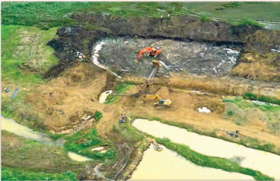
Koneellista kullankaivua Lemmenjoen Puskulla kesällä 2013. Kaivu on aloitettu oikeaoppisesti siirtämällä turvemaat sivuun. Turveauma suojaa samalla tulvaveden valumiselta kaivukuoppaan. Ylälaidassa näkyy lisäsuojaksi tehty ojasysteemi. Vanhat kaivukuopat toimivat kiertovesi- ja selkeytysaltaina. Aivan vasemmassa laidassa oleva erityisen vehreä niitty on aiemmin maisemoitua kaivualuetta.
